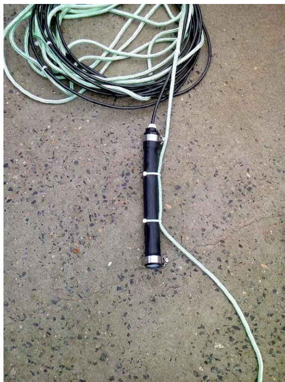
Figura A5 – Exemplo de forma de montagem da sonda de nível com câmara de bicicleta.
