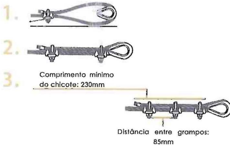
Figura 8 - Modo de Fixação de Grampos
