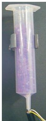
Figura A4 – Desumidificação do tubo de respiro com sílica gel.
