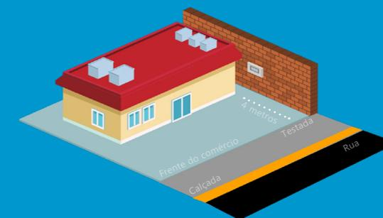
A caixa-padrão deve ser instalada na testada do imóvel, no limite entre o terreno e a calçada.
