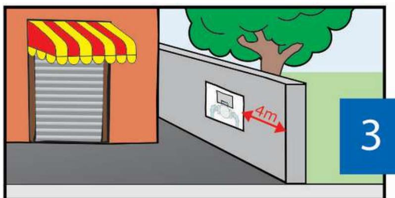
Em comércios com estacionamento aberto, a caixa-padrão pode ser instalada no muro lateral, com distância máxima de 4m da testada do imóvel.
