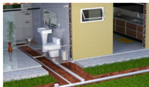
5 - Instale a válvula de retenção ainda no terreno do imóvel, antes da conexão com a rede coletora da Companhia;
