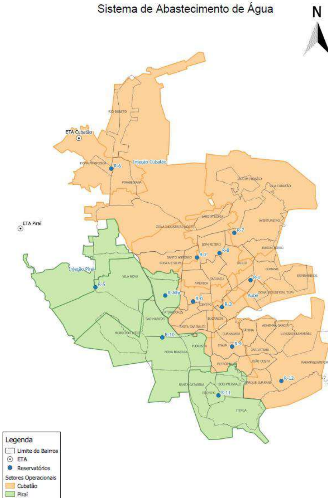
Figura 1 – Sistema de Abastecimento de Água da CAJ
