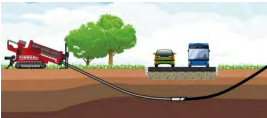
Figura 13 – Furo Direcional passando sob sistema viário
