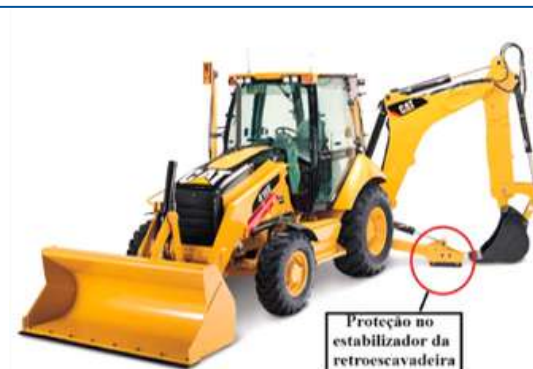
Figura 10 - Proteção do estabilizador da retroscavadeira
