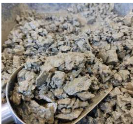
Material na umidade ótima para compactação
