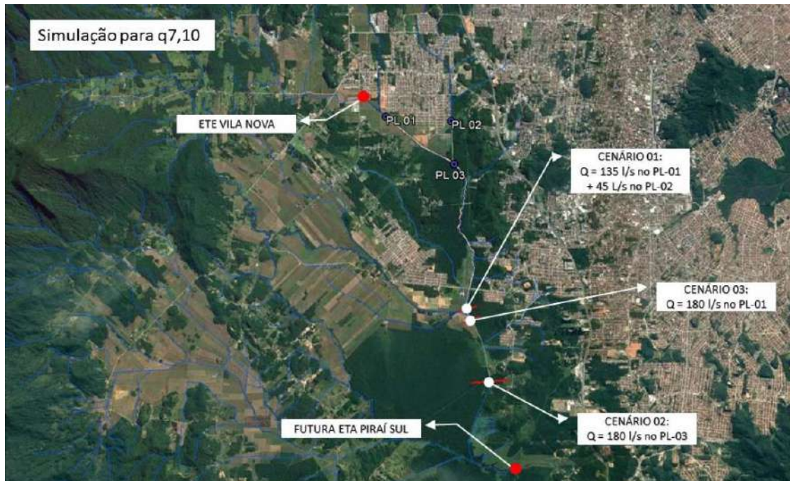
Figura 27 – Locais alternativos para o ponto de lançamento (PL) do efluente tratado da ETE Vila Nova
