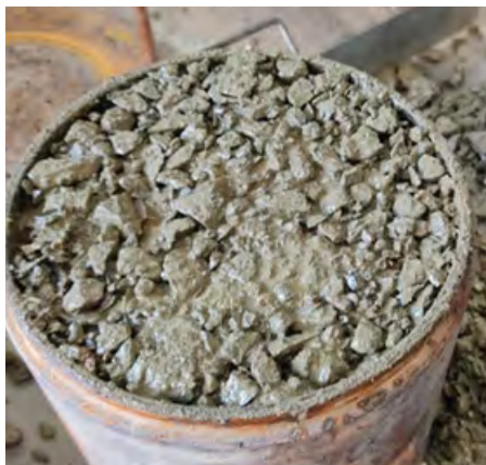
Material compactado na umidade ótima
