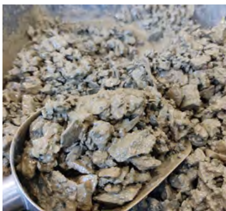
Material na umidade ótima para compactação
