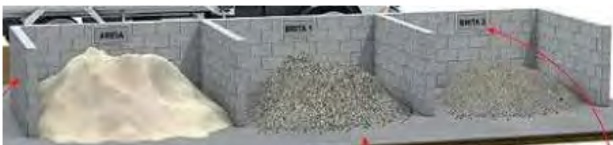
Figura 1 – Separação de materiais por diferença de granulometria
