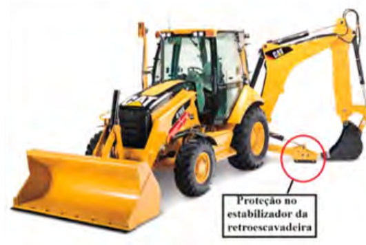
Figura 10 - Proteção do estabilizador da retroescavadeira
