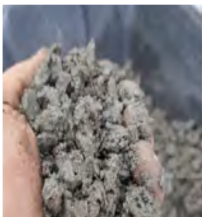
Material na umidade ótima para compactação com reconhecimento tátil em campo
