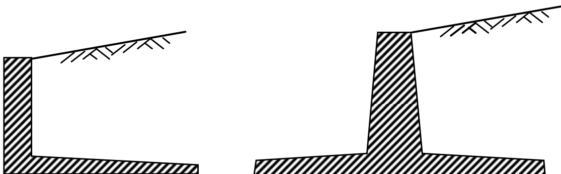
Figura 22 – Muros de arrimo do tipo cantilever
