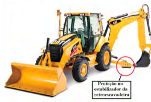
Figura 10 - Proteção do estabilizador da retroescavadeira
