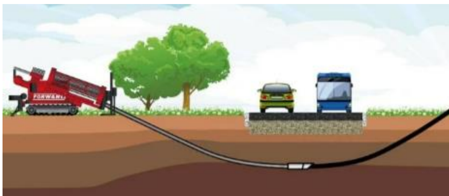
Figura 17 – Furo Direcional passando sob sistema viário
