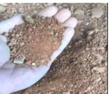
Todo material para aterro e reaterro provenientes de jazidas deve ser aprovado pela CTE. O material deve ser isento de contaminação, impurezas e não apresentar características de material argiloso.
