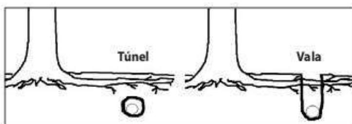
**Instalações subterrâneas podem ser colocadas na proximidade das árvores sem danificar as suas raízes através da abertura de túneis. Uma alternativa consiste em abrir valas cuidadosamente com um martelo pneumático ou manualmente.**
