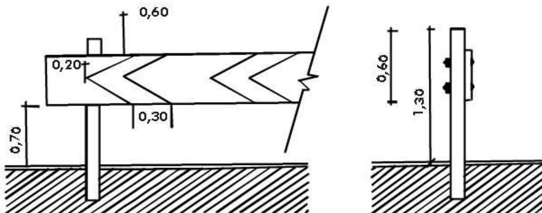
Figura 8 – Detalhe dos postes de sustentação das placas
