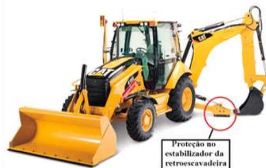
Figura 10 - Proteção do estabilizador da retroescavadeira
