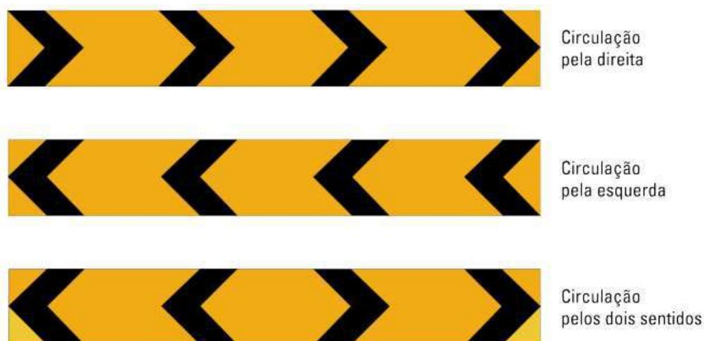
Figura 6 – Modelo de placas para bloqueio parcial
