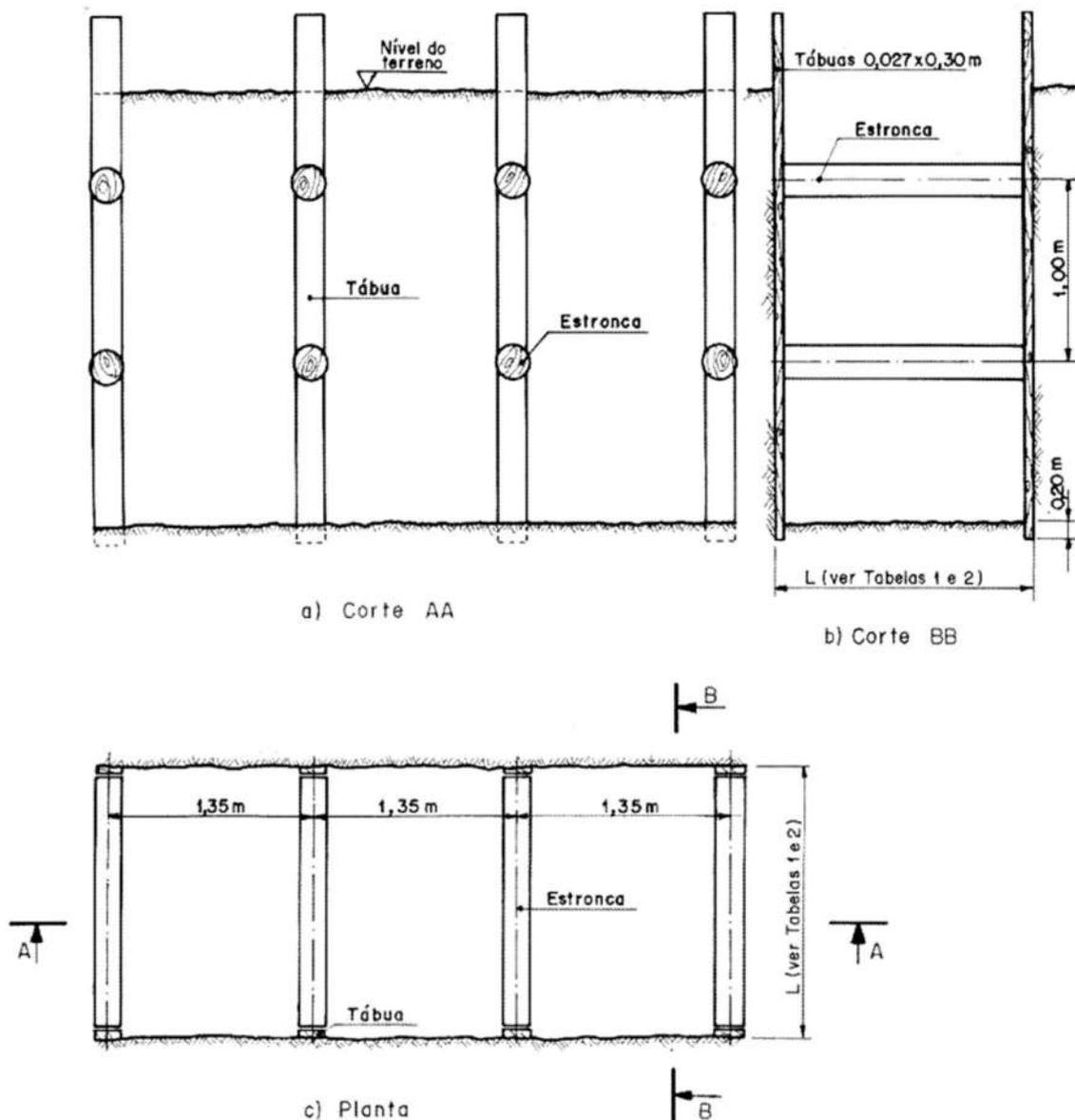
Figura 11 – Detalhes de escoramento tipo Pontalete
