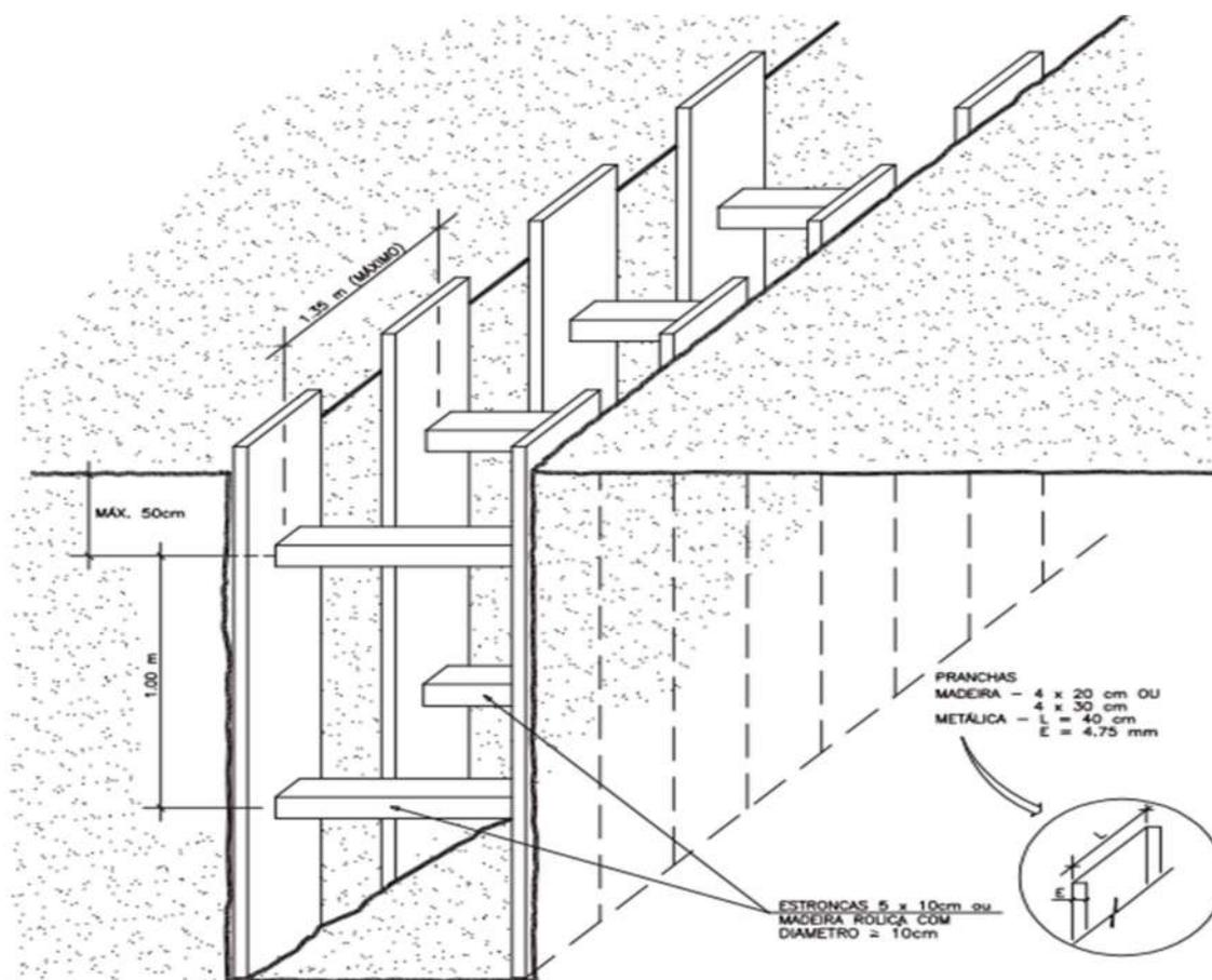
Figura 16 – Detalhe de escoramento tipo Pontaleta Metálico
