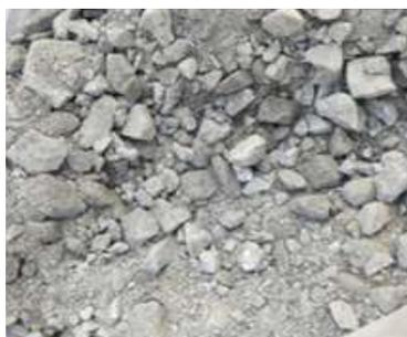
Exemplo de bica corrida isenta de contaminação e impurezas; necessário o controle de umidade para compactação do material. O controle de umidade deve ser realizado no canteiro de obras, *in loco*. Deve-se atentar ao cuidado para manter a umidade (depositar o material em local com sombra e proteger com lona durante a sua utilização, se necessário realizar a correção de umidade em campo).
