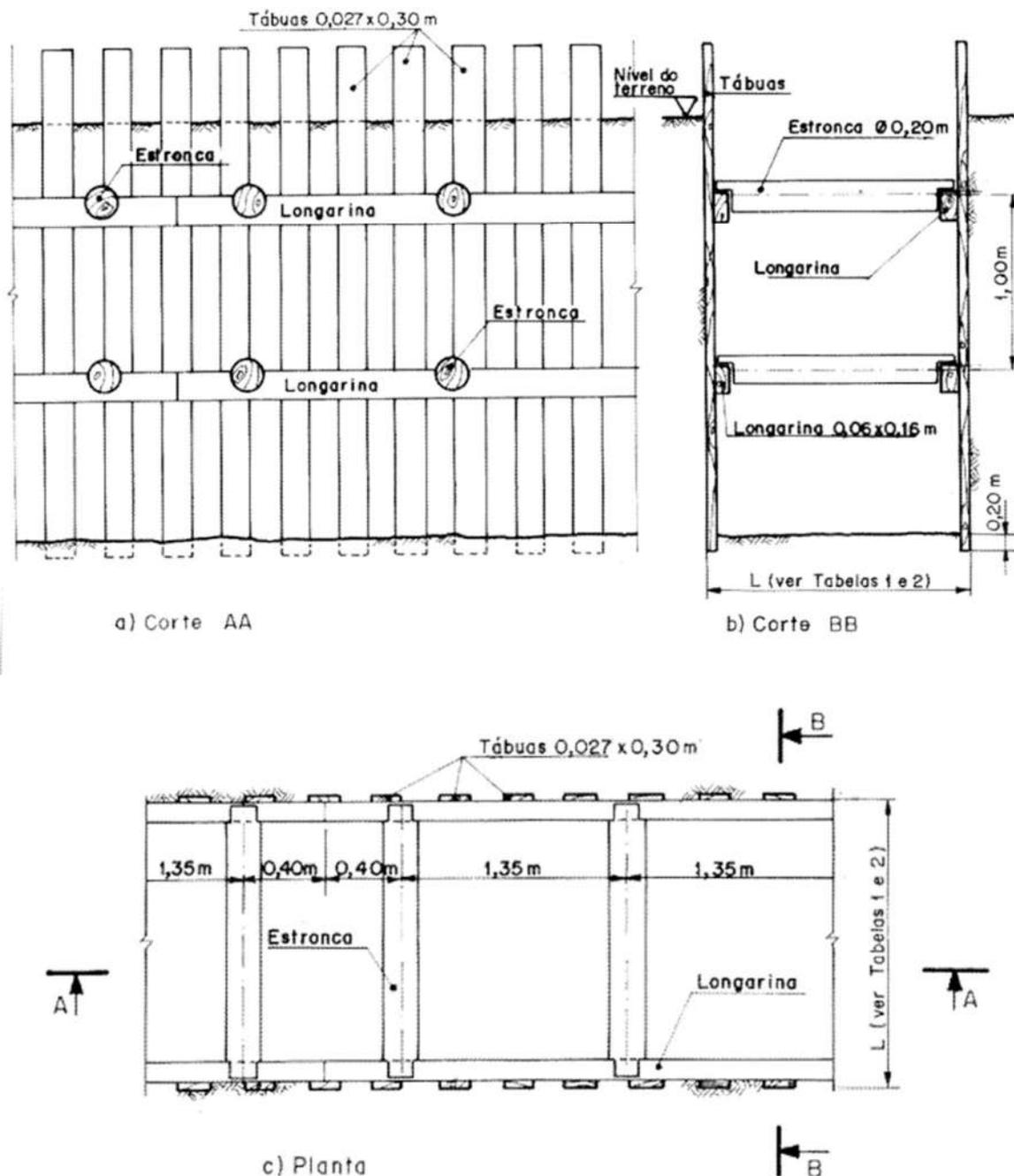
Figura 12 – Detalhes de escoramento tipo Descontínuo
