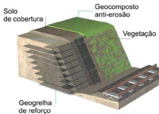
Figura 27 – Aplicação de geogrelha em talude
