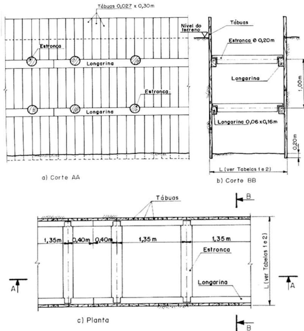
Figura 14 – Detalhes de escoramento tipo Contínuo
