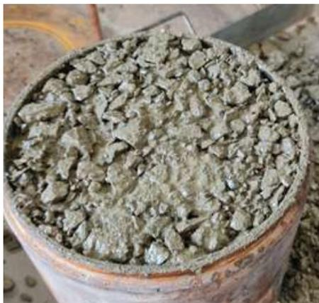
Material compactado na umidade ótima
