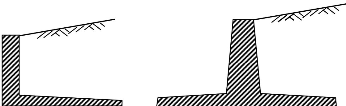
Figura 22 – Muros de arrimo do tipo cantilever
