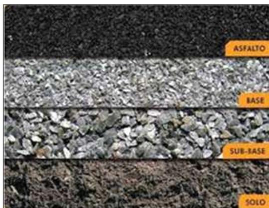
Perfil de vala demonstrativo; utilizar os materiais e espessuras informados no Termo de Referência de cada contrato. Os materiais utilizados (BGS - Brita Graduada Simples - e Rachão) devem ser isentos de impurezas e contaminação e passar pela aprovação do Controle Tecnológico.
