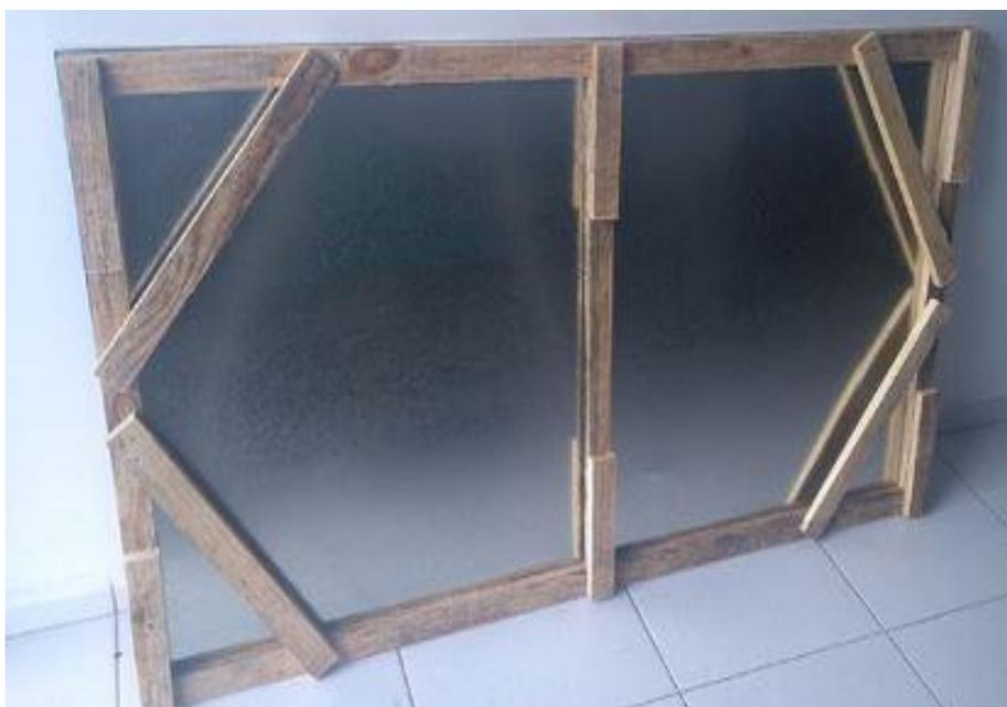
*Figura 1 - Modelo de placa produzida em chapa de aço galvanizado e quadro de madeira.*
